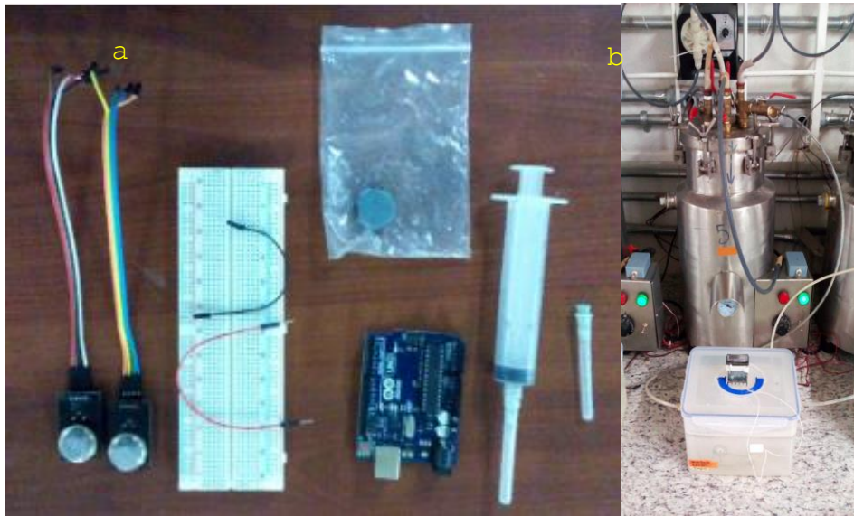
Figura 7.1 a) Material empleado durante la prueba de sensores y b) Digestor anaeróbico experimental
